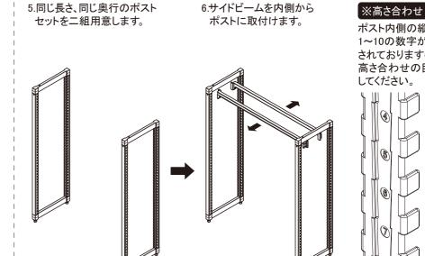
ポスト内側の縦溝に 1~10の数字が打刻 されておりますので、 高さ合わせの目安と してください。
