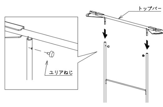
③上支柱フレームを下支柱フレームに差し込み任意の高さで固定します。
