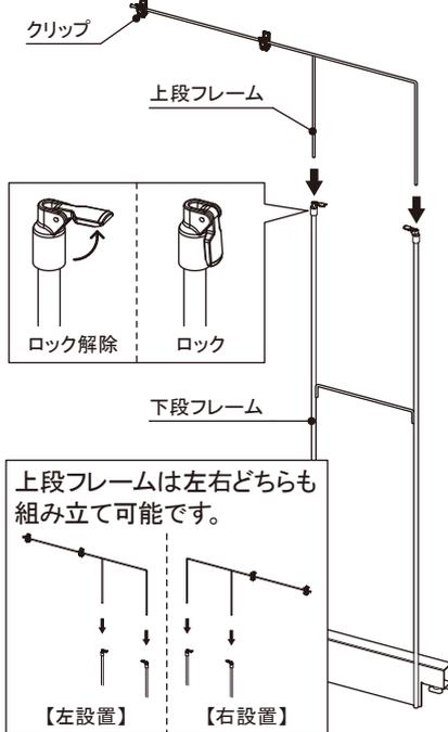
②上段フレームにパネルSを取り付けます。
