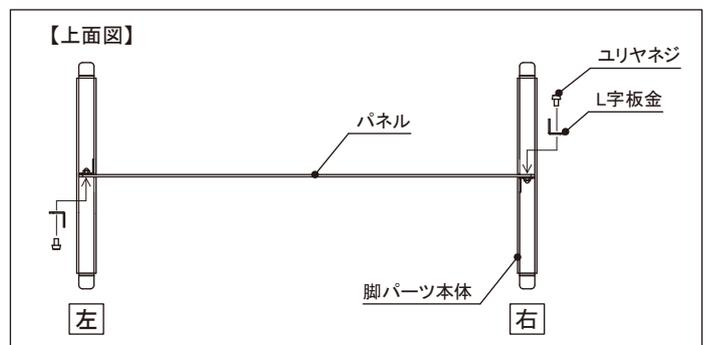
2. L字板金と脚パーツ本体でパネルを挟み込むように、付属のユリヤネジで固定します。
