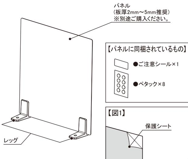
※2mm以下のパネルを使用する場合、レッグとパネルの密着度は落ちます。
